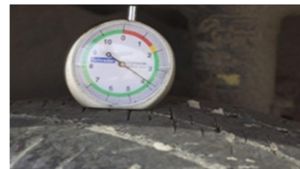
Гуми: Основа на длабочина на шара < 7 mm Забелешка: Абењето на гумите се мери според најдлабоката шара на гумата.
