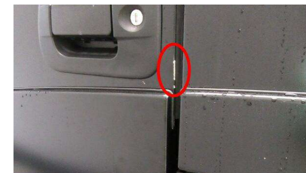
Пукнатина на работ на вратата
